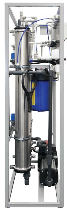
В WiseWater WWRO есть возможность подключения блока промывки (CIP), который позволяет промывать мембранные элементы. Каждая система оснащается контроллером для управления, а также кондуктометром (TDS метром) для контроля качества очищенной воды (электропроводности пермеата).
